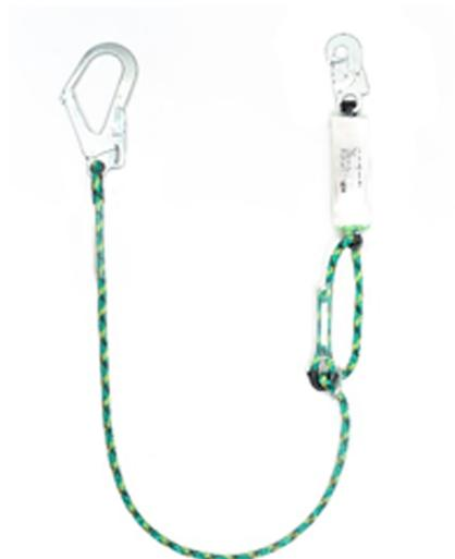
Строп страховочный с амортизатором веревочный SKS-2 предназначен для остановки падения и поддержания человека после остановки падения. Строп состоит из полиамидной веревки (каната) диаметром 12 мм. На изделии регулируется длина и размещен амортизатор рывка, один маленький карабин с зевом раскрытия 18 мм и один большой карабин с зевом раскрытия 55 мм. Максимальная длина стропа - 2 м.
