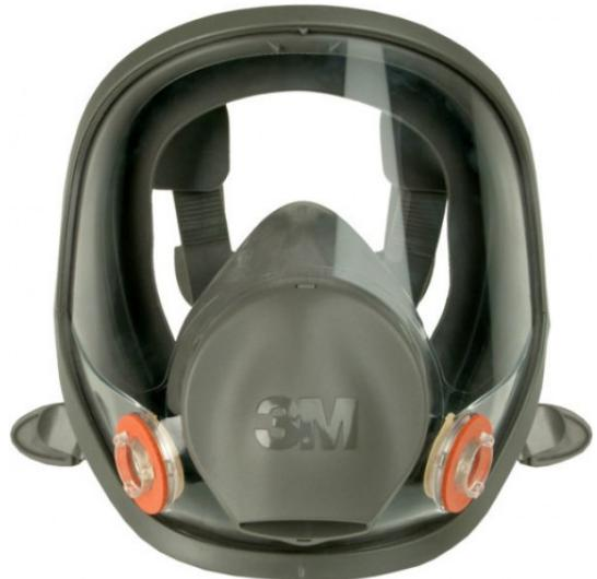
Лицевая часть маски состоит из силиконсодержащего эластомера, который прекрасно поддерживает температуру, близкую к температуре лица. Линза выдерживает кратковременное химическое воздействие, стойко переносит удары и царапины.
