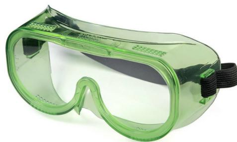
Лёгкие очки с прямой вентиляцией в мягком корпусе из ПВХ и регулируемой наголовной лентой с защитным стеклом из бесцветного поликарбоната. Защита от механического повреждения высокоскоростными летящими частицами со среднеэнергетическим ударом, устойчивы к растворам кислот и щелочей.
