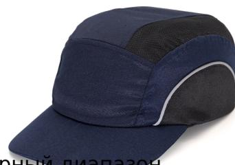
Материал ударопрочной вставки выполнен из ПНД. Температурный диапазон использования: от -10 до +50. каскетка защищает от удара головой о неподвижные предметы. Амортизатор изготовлен из пенополиуретана. Размер регулируется с помощью ленты с застежкой Velcro. На изделии размещены светоотражающие вставки и 4 вентиляционных отверстия.
