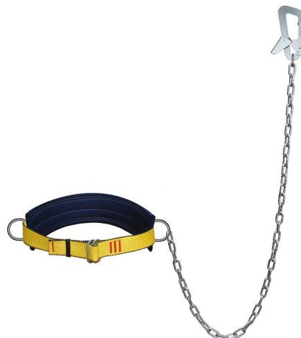
Удерживающая система УС 1Г (УП I Г) представляет собой безлямочную удерживающую систему (пояс). Удерживающая система (пояс со стропом) предназначена для выполнения функций удерживания и поддерживания рабочего на определенной высоте. Изделие не предназначено для использования с целью страховки при падении. Состав: ремень, кушак, два элемента крепления для рабочего позиционирования, строп Г (цепь) с монтажным карабином.
