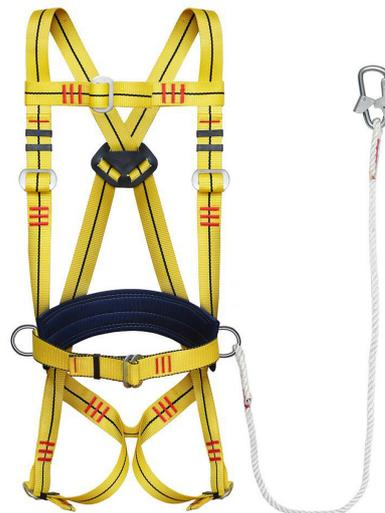
В удерживающей страховочной привязи УСП 2Ж расположен ремень с пряжкой, позволяющий подгонять пояс по фигуре человека. Также привязь включает кушак, наплечные и набедренные лямки, элементы крепления – два металлических D-кольца на ремне привязи и одно на спине, строп из полиамидного каната с монтажным карабином.
